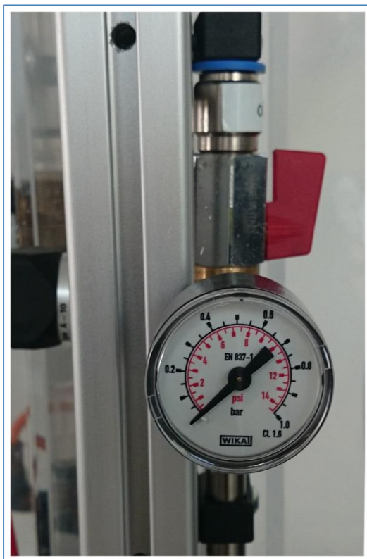
Abbildung 6: Optionale Druckregelung hinter der regelbaren Pumpe M3
