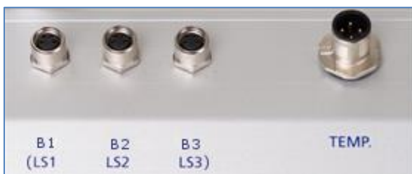
Abbildung 8: Anschluss der Füllstandsschalter und des Pt100
